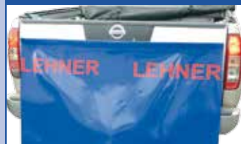
Spritzschutz 90 cm hoch, oben und unten Hohlraum
