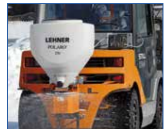
POLARO® 170 am Gabelstapler mit Schneeräumschild
