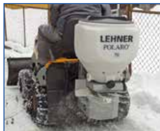
POLARO® 70 am ATV mit Schneeräumschild
